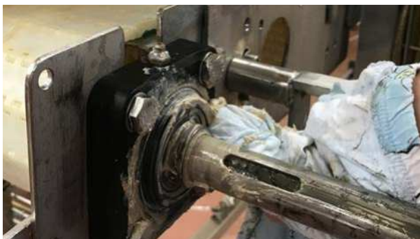
Pracownik ściera na sucho z łożyska smar szmatą, która zostanie w końcu spalona.
