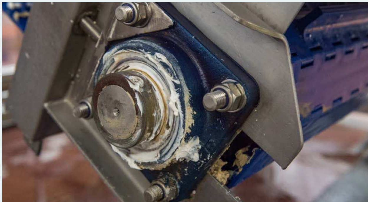
Nadmiar smaru z łożysk zgromadził się na higienicznej taśmie przenośnika i wzrosło ryzyko utraty bezpieczeństwa żywności na skutek przedostania się bakterii oraz alergenów do strefy przepływu żywności.
